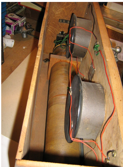
De binnenzijde van het toestel bevat twee spoelen met een schuifcontact en twee afstemcondensatoren.
